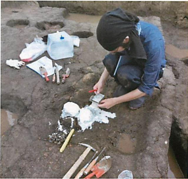
写真. 仲島遺跡(大野城市)の竈跡における考古地磁気測定用試料の採取の様子。過去の地磁気の方位を測定するため、水平面や現在の地磁気の方位を試料に記録して定方位試料を採取する。
