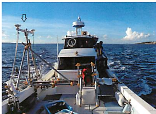
図1. 浅海域マルチビーム測深の調査風景。矢印はGPS。水面下にビームを発振するトランスデューサーを設置。
