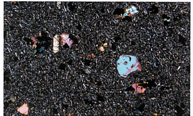
九大筑紫地区遺跡出土の今山系石斧の偏光顕微鏡写真。この石材は、岩石組織、鉱物化学組成、全岩化学組成のすべての項目で今山産の玄武岩と一致する。
